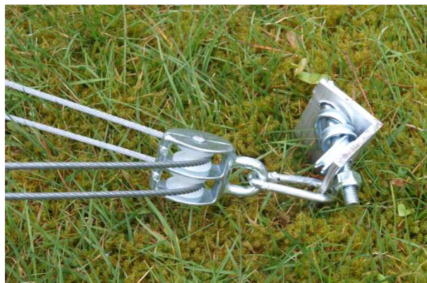
Abbildung 12: Bodenanker mit Umlenkrolle für die Zugseile zum Aufrichten. Die Ausführung ist ggf. abweichend.
