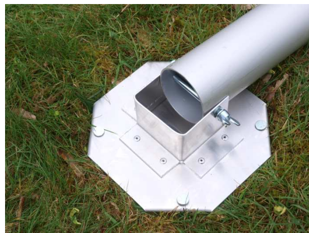
Abbildung 9: Unteres Mastsegment mit der Schraube als Gelenk; Die Bodenplatte ist mit 4 Nägeln gesichert
