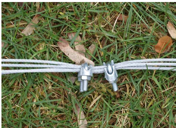
Abbildung 16: 2 x 2 Zugseile mit festgezogenen Seilklemmen.
