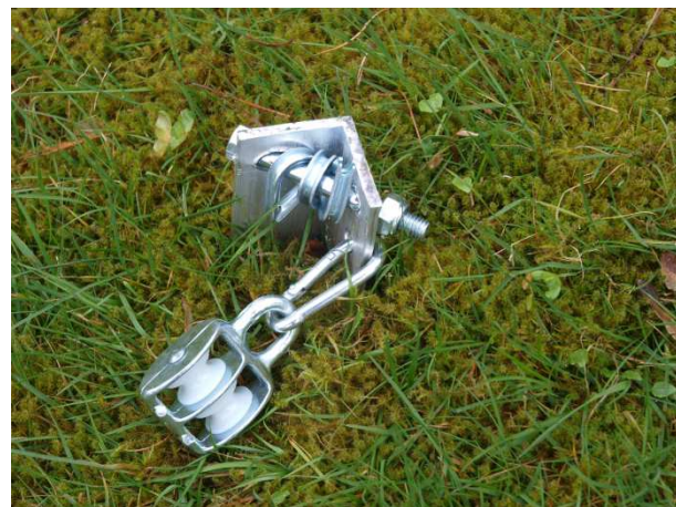
Abbildung 10: Einer der beiden Bodenanker mit Umlenkrolle bei den 15 m Masten. Die Umlenkrolle kann je nach Ausführung der Bodenanker ggf. anders befestigt sein.
